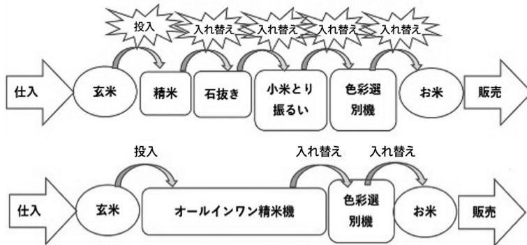
図表 改善前の精米工程（上）と改善後の精米工程（下）
