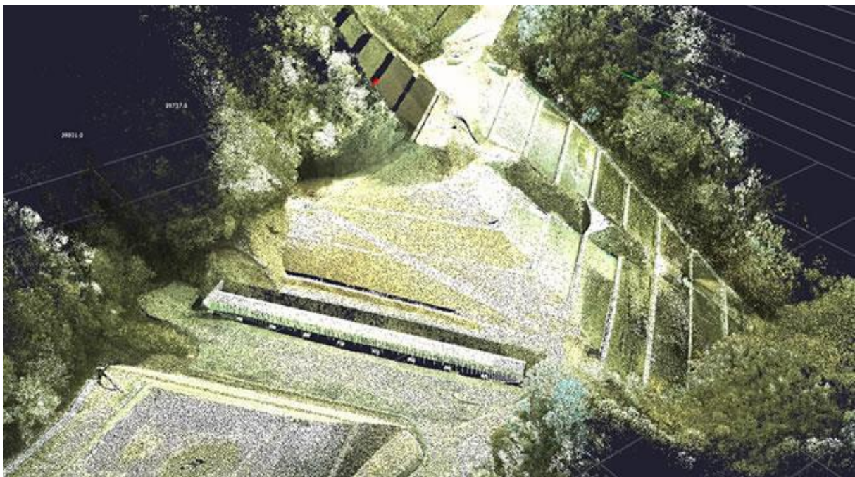
図表 1-12 工事着手前の三次元測量データ
