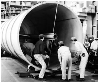
化学工場用薬品タンクの製缶作業
